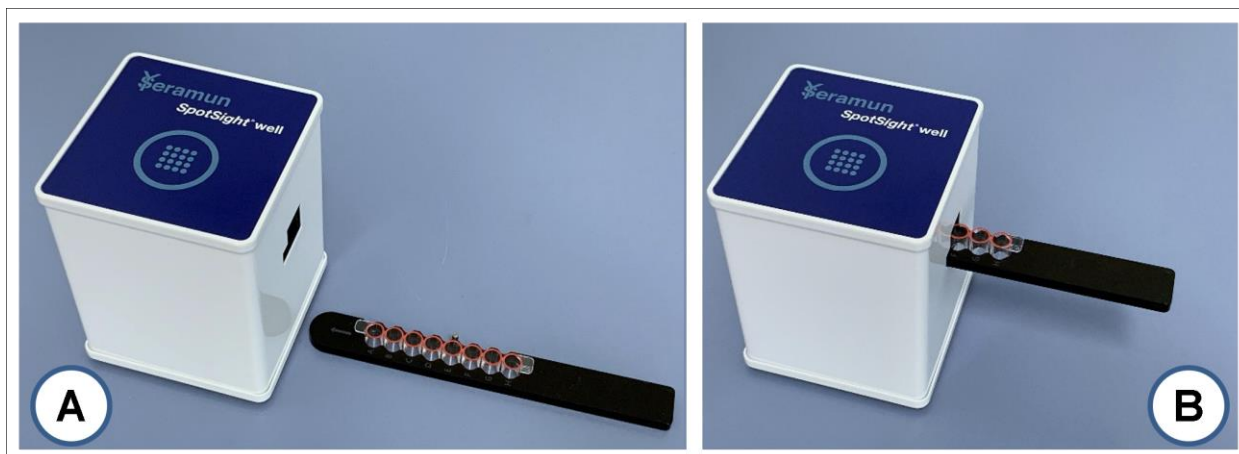
Obrázok 6: Používanie držiaka jamiek (A) Pred zasunutím držiaka jamiek (B) Prístroj so zasunutým držiakom jamiek
