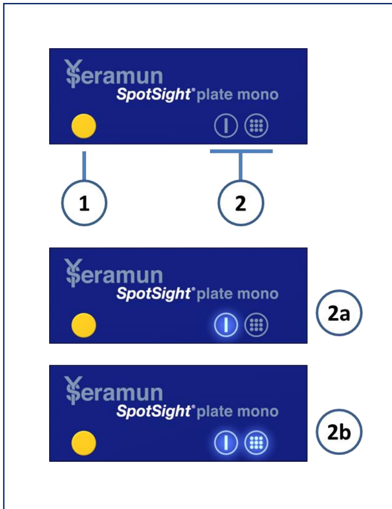
Rysunek 4: Przedni panel skanera Seramun SpotSight ® plate mono, wskaźniki na przednim panelu
