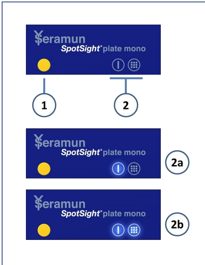
Фигура 4: Скенер Seramun SpotSight® plate mono, изглед на предния панел, функционални индикатори
